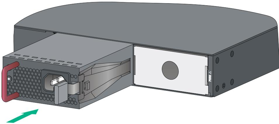
图2-29 PSR1110-56A 安装完成示意图
