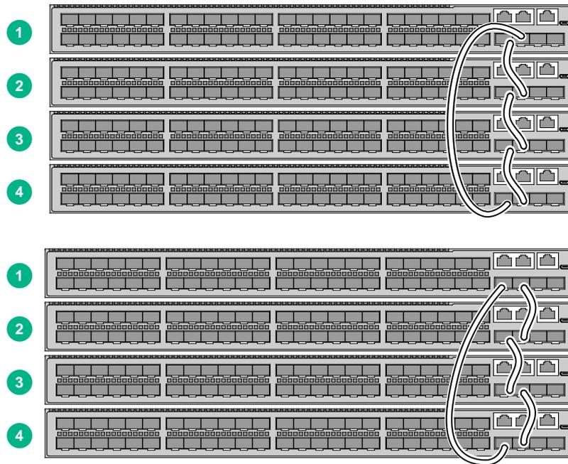
上述连接方式对应的是比较直观的环形拓扑，便于后期维护。拓扑连接关系如[图 4-5](#)所示。
