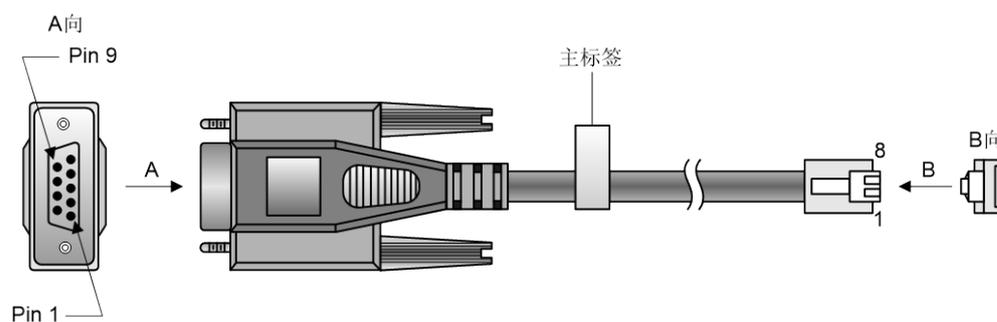
表3-3 串行 CONSOLE 口电缆连接关系
