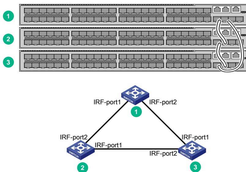
S5200S-EI & S5200S-HI 系列交换机能够通过 SFP+接口提供 10GE 速率的 IRF 物理连接。
