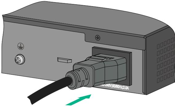
图2-33 固定电源机型交流电源线连接示意图（以 S5200S-52S-EI 为例）
