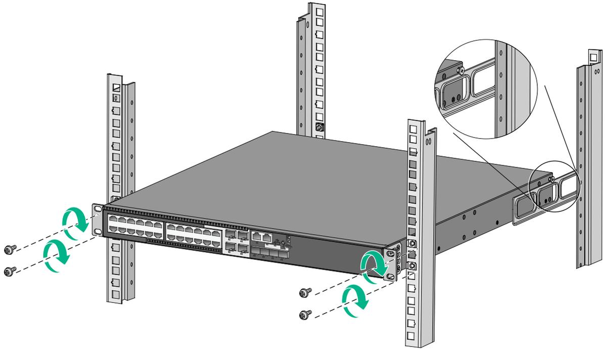
图2-16 安装交换机到机柜示意图（后挂耳反向安装到机柜方孔条）
