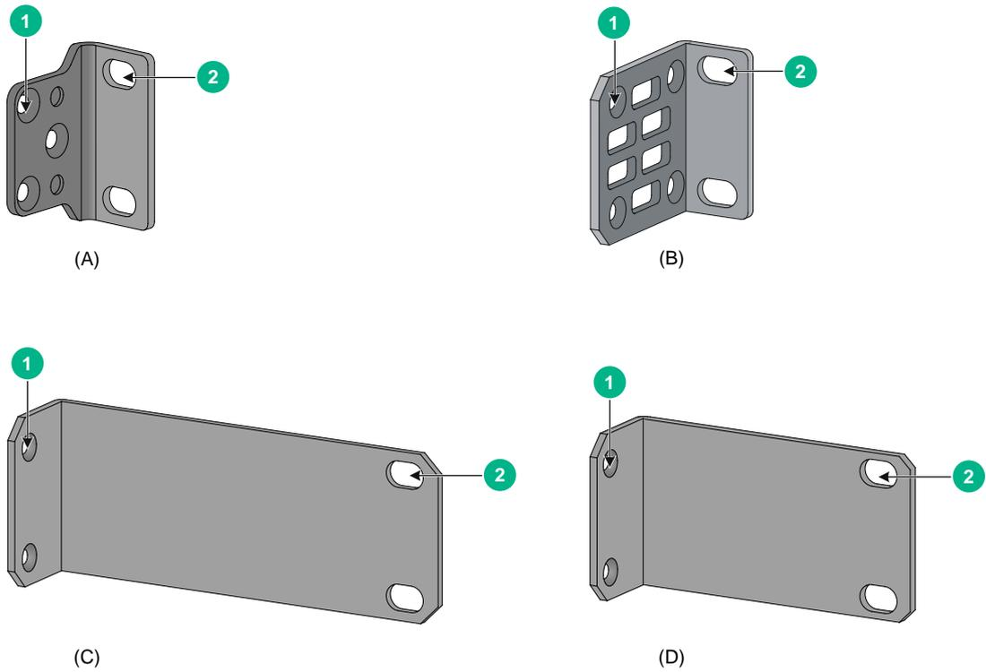
(1): 安装前挂耳到交换机的螺钉孔
