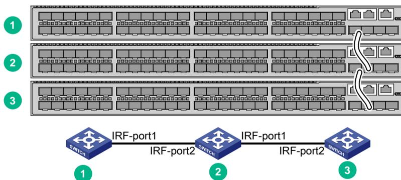
图4-3 IRF 环型连接方式及对应的拓扑示意图
