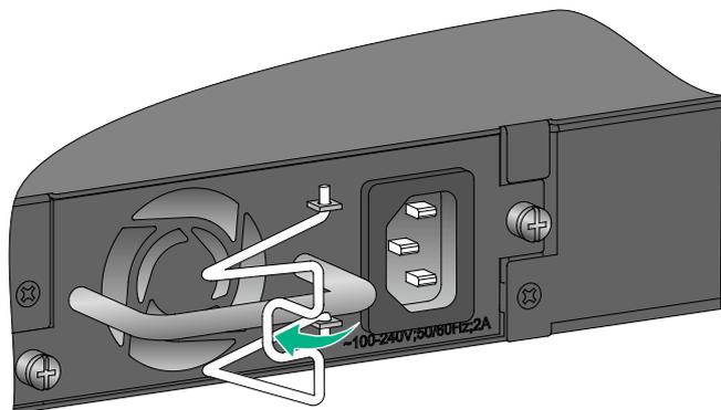
图2-35 PSR150-A1 电源线连接示意图（二）
