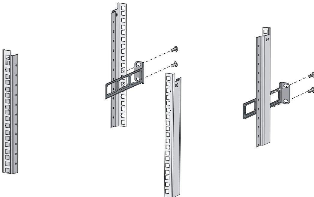
图2-14 反向安装后挂耳到机柜方孔条示意图
