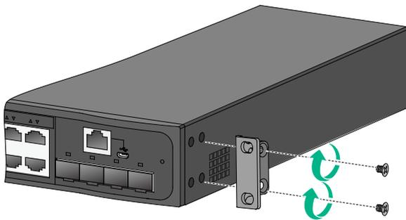
图2-7 安装挂耳 B 到机箱的示意图（采用端口侧挂耳安装位，以 S5200S-52F-EI 为例）
